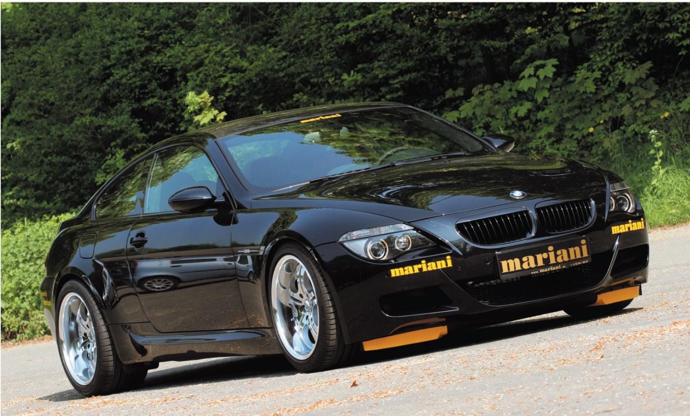
Das Fahrzeug erhielt an der Vorderachse 9,5x19 und 11x19 Zoll Leichtmetallfelgen an der Hinterachse (auf Wunsch auch in Chrom). Bei der Bereifung wurden uns die Größen 255/40 und 325/30 ZR19 angegeben!
